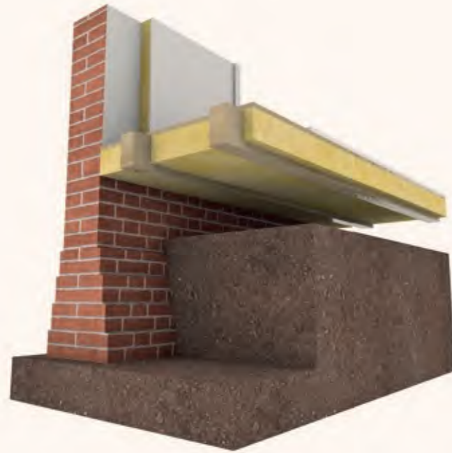
Vloerisolatie – tussen de balken geplaatst toegepast zonder dampremmende folie, bij deze constructie is die overbodig. Afbeelding Stichting ERM
